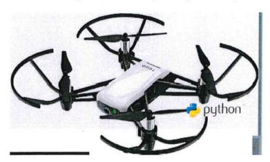
Drohnen können nicht nur mittels einer App per Smartphone oder mit einer Steuereinheit geflogen werden, sie können auch Befehle von einem Programm erhalten. Von der Firma Ryze Tech wird eine Drohne namens Tello hergestellt, die sich mit der Programmiersprache Python programmieren lässt. Diese Programmiersprache ist der Programmiersprache C# ähnlich und ebenfalls objektorientiert.
